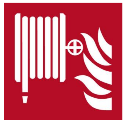
Brandschutzzeichen für Wandhydranten
